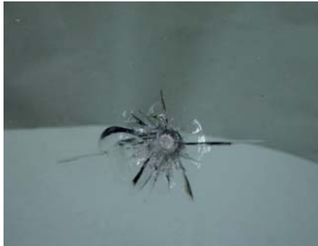
Steinschlag in der Frontscheibe.
