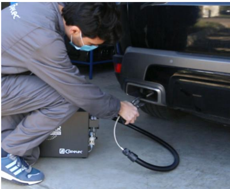
Messung der Partikelanzahlkonzentration, Bild: www.capelec.com
